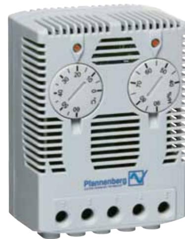
La serie de los higróstatos FLZ acciona los ventiladores con filtro o los calentadores para armarios eléctricos al superar un porcentaje de humedad relativa del aire preconfigurado. Por lo tanto, la humedad relativa es mantenida por encima del punto de rocío, previendo la formación de líquidos de condensación en los componentes eléctricos y la corrosión de las chapas no protegidas.
