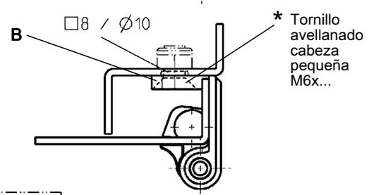
Bisagra en zamak negro, pasador de fijación en poliamida GF negra, eje en acero inox, arandela y tuerca en acero cincado
