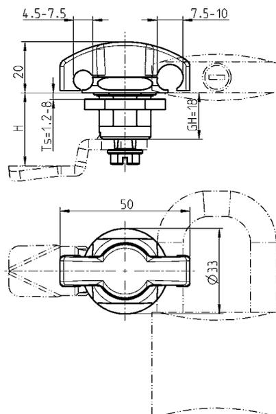
Palomilla y carcasa en zamak negro, tuerca y tornillo en acero cincado, con junta
