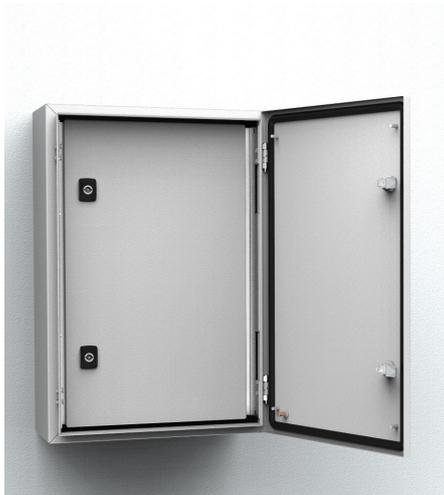
**Descripción:** Para controladores, medidores luminarias, etc. Se pueden instalar bisagras para permitir la apertura a derecha o izquierda. Accionamiento de cierre DIN 3 mm. Las puertas con altura de 700 mm y superiores llevan 2 cierres. Profundidad útil entre el interior y la puerta exterior: 35 mm. Ajustable en profundidad con el accesorio AMG. Área de montaje: A-55, An-108. En armarios de acero inoxidable se requiere mecanizado.
