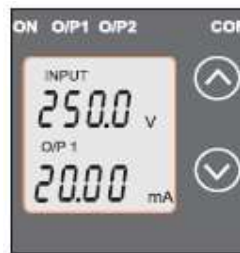
Pantalla 4: Entrada y salida de voltaje 1 como corriente
