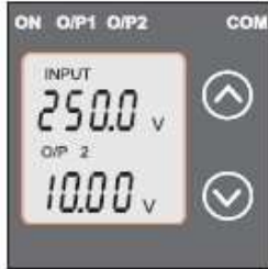
Pantalla 5: Entrada de voltaje y como voltaje
