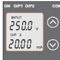
Pantalla 6: Entrada y salida de voltaje 2 Salida 2 como corriente
