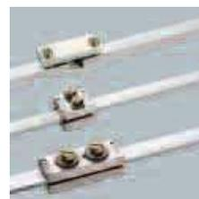
A temperaturas ambiente normales ha dado buen resultado a partir de una longitud de sistema de 5 m el uso de una unión dilatante. La distancia a aplicar en el caso específico para los conectores dilatantes depende de las condiciones de uso concretas, como, por ejemplo, estructura y dotación del sistema, magnitud y rapidez de variaciones de temperatura.
