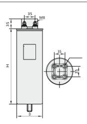
Nota: La capacidad del condensador trifásico (1~8)kvar puede observarse en la Imag.1; la del de (10~25)kvar en la Imag.2; la del de (30~40)kvar en la Imag.3. El condensador de compensación de fase partida cuenta con 4 terminales de conexión con conexión de estrella y conductor de salida de línea de neutro N, como se muestra en la Imag.4.
