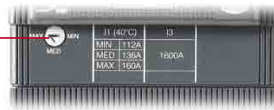
Umbral térmico Regulable de 0,7 a 1 x In
