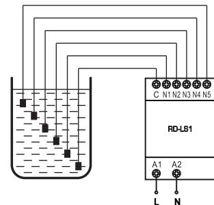
El indicador de nivel de líquido se utiliza para indicar los diferentes niveles en tanques o pozos. Tiene función de alarma con pitido.
