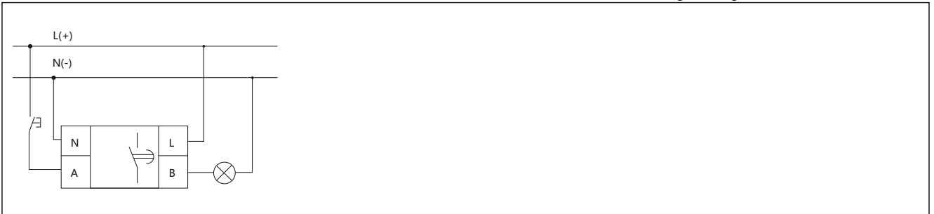
Imagen 3: Diagrama de cableado del relé NTE8-□B
