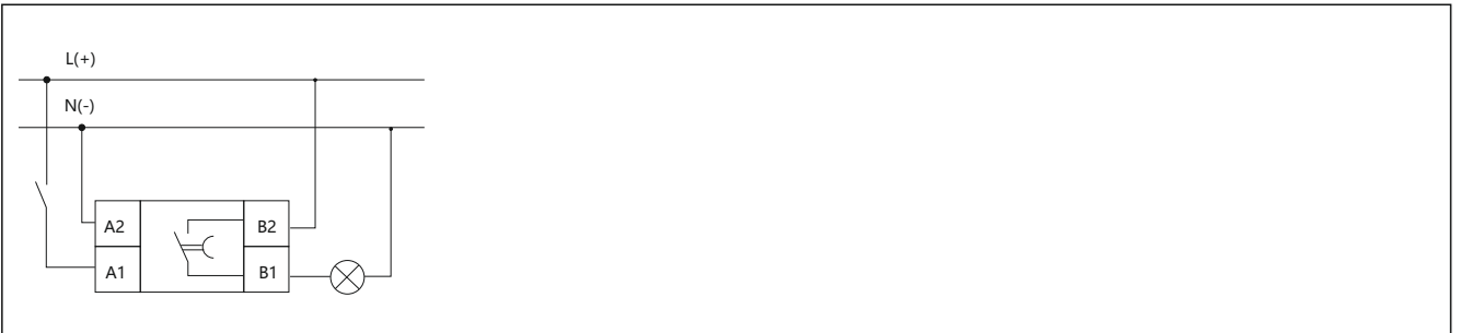
Imagen 3: Diagrama de cableado del relé NTE8-□B
