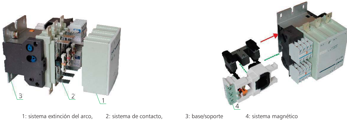
Estructura básica de los NC2-115~265
