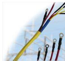
**MANGAS TERMOCONTRAIBLES, 1000V, CON ADHESIVO; CONTRACCION 3:1, MATERIAL POLYOLEFINA, LIBRES DE HALOGENO, TEMP. OPERACIÓN -45°-125°C; TEMP. CONTRACCION 105°C.**
