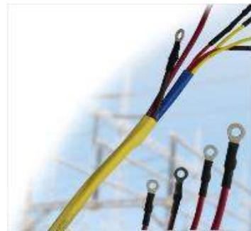
**MANGAS TERMOCONTRAIBLES 1000V (POLYOLEFIN), TERMOCONTRACCION 2:1; LIBRES DE HALOGENOS; TEMP. OPERACIÓN -45°-125°C; TEMP. CONTRACCION 120°C.**
